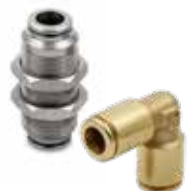
Raccordi automatici in ottone senza piombo serie F-E e F-NSF, tubi da Ø 4 a 10 mm, filetti da M5 a 1/2".
